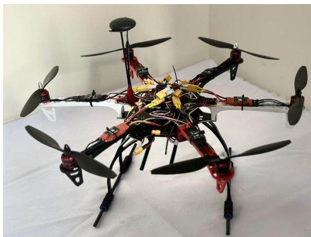
а) Конструктивная схема гексакоптера и электронные компоненты
